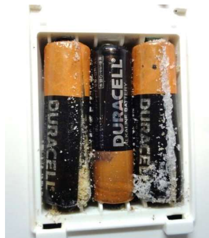
図7. 電池液漏れで白い結晶が付着
