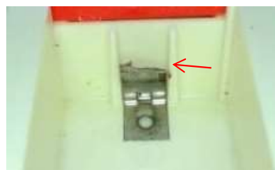
図3. 折れの例 端子の先が折れて無くなっている
