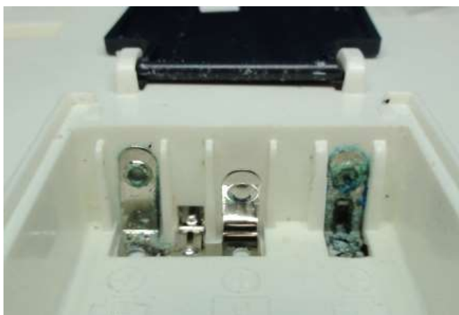
図8. 漏れた強アルカリ性の電解液で青錆びと白い粉が端子に付着
